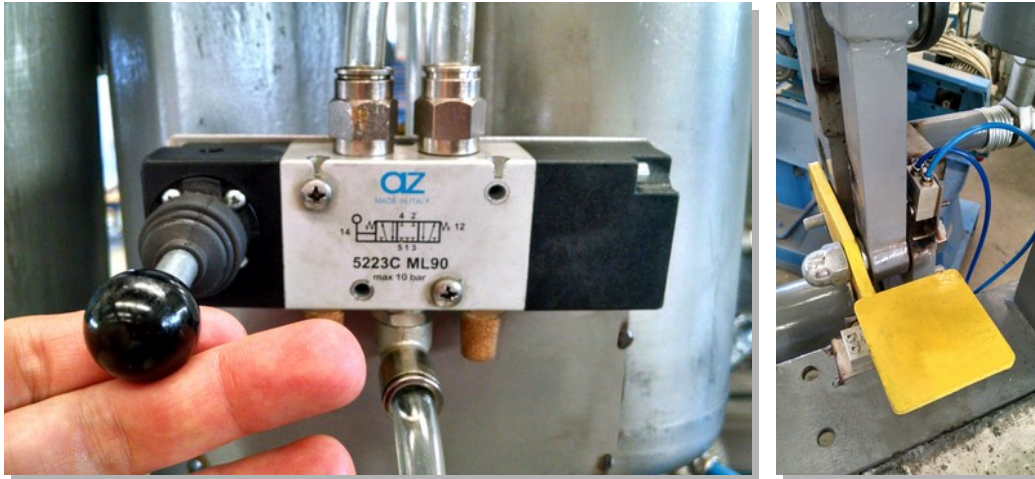
11. ábra: a. Joystick-kal ellátott vezérlő, b. Végálláskapcsolóval ellátott zárópedál
