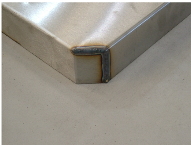
Hegesztési nyom felületkezelés előtti állapotban
